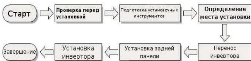
Рисунок 2 Схема установки
